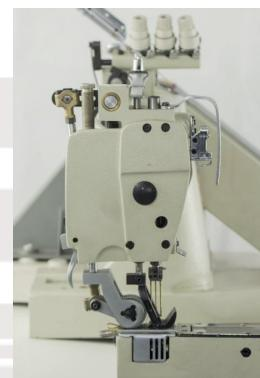
Máquina cerradora de codo de dos o tres agujas con puntada de cadena para materiales livianos, pesados y semi pesados, con puller de arrastre y motor industrial.
